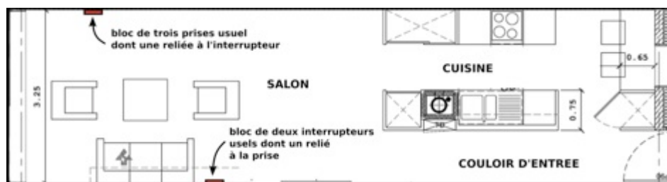
Figure 2 : Situation de l'interrupteur coupeur de prises dans le logement. Source : Renault, 2012.
